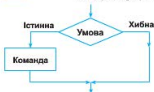
Рис. 3.37. Блок-схема з розгалуженням у скороченій формі і відповідний С-блок у середовищі Scratch
