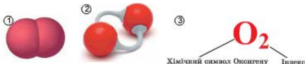
Рис. 11.1. Моделі молекули кисню: 1. Масштабна. 2. Кулестержнева. 3. Знакова
