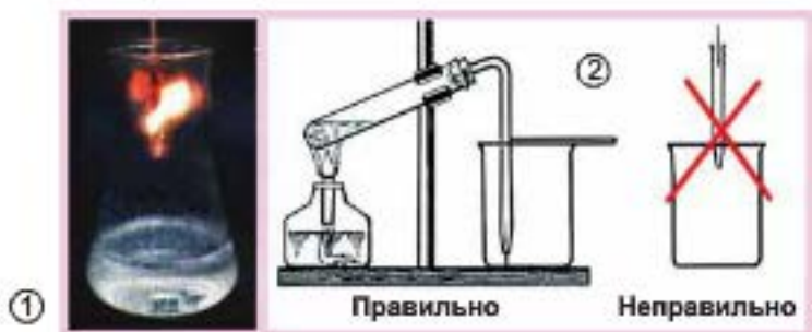
Рис. 20.1. Добування кисню термічним розкладанням гідроген пероксиду (1) і схема збирання газу витісненням повітря (2)
