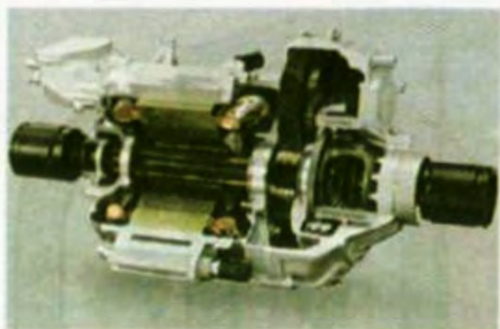
Мал. 126. Розріз електро- двигуна постійного струму
