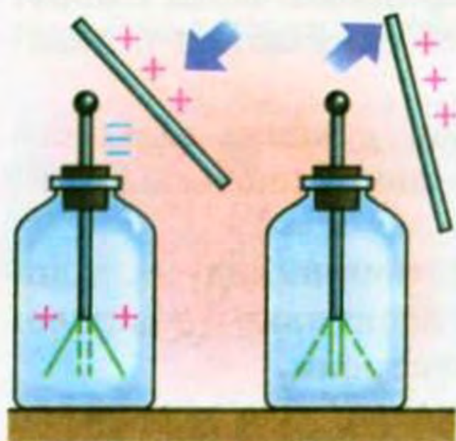
Мал. 14. Перерозподіл заряджених частинок в електроскопі під дією електричного поля
