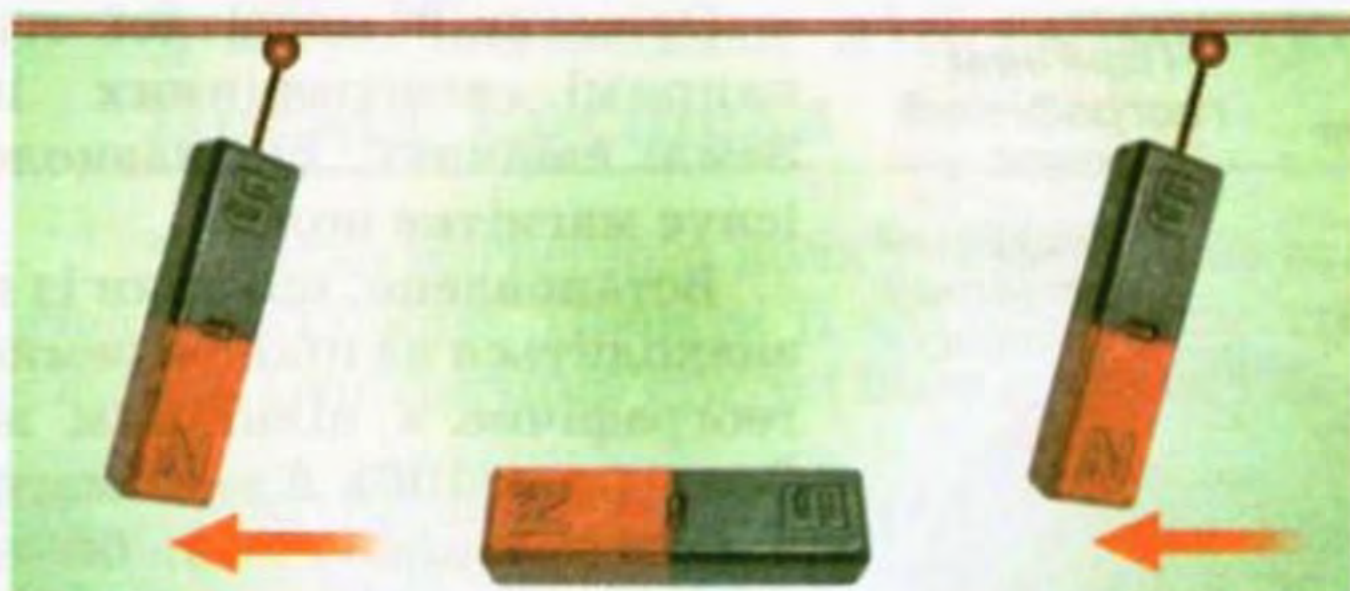
Мал. 104. Взаємодія полюсів постійних магнітів
