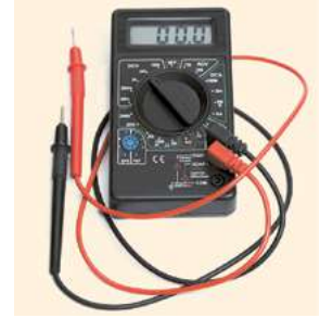
Рис. 35.6. Мультиметр, складовою частиною якого є амперметр
