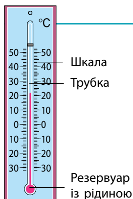
Рис. 10.4. Будова рідинного термометра
