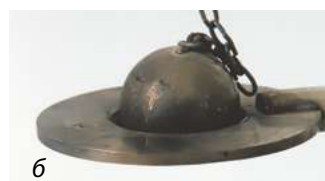
Рис. 11.2. Пристрій Гравезанда: а — за кімнатної температури металеву кульку проходить крізь кільце; б — у нагрітому стані металеву кульку не проходить крізь кільце
