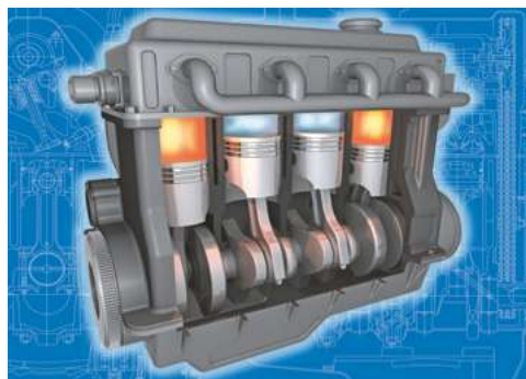
Рис. 25.3. Чотирициліндровий двигун внутрішнього згоряння
