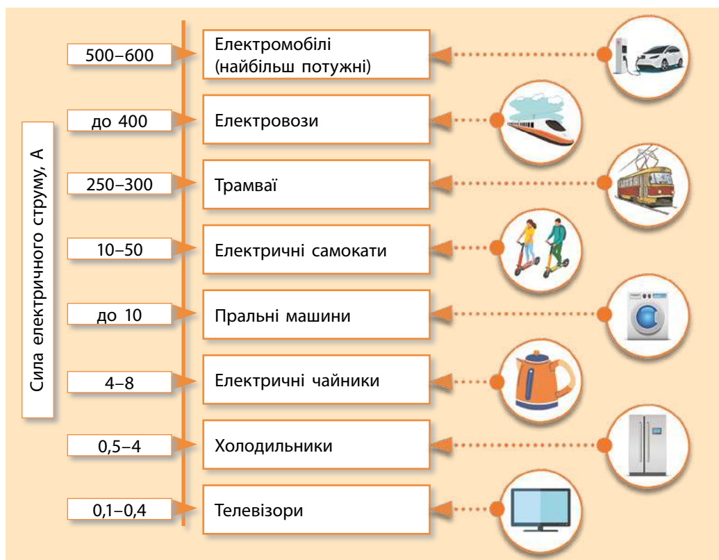
Рис. 35.4. Значення сили струму в деяких електротехнічних пристроях
