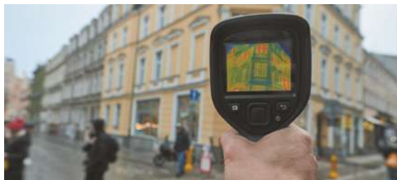
Рис. 15.4. Аналіз енергоефективності будинку за допомогою тепловізора
