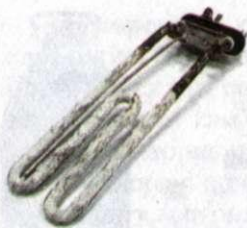
Рис. 77. Нагрівальний елемент, покритий шаром накипу
