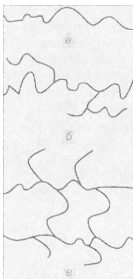
Мал. 122. Будова макромолекул: а — лінійна; б — розгалужена; в — сітчаста
