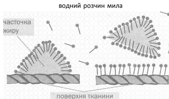
Мал. 80. Мийна дія мила: а — сполучення іонів із часточкою жиру; б — відокрем- лення часточки жиру від тканини
