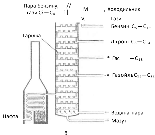
Мал. 44. Схема установки для перегонки нафти: а — трубчаста піч; б — ректи- фікаційна колона
