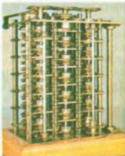
Рис. 2.51. Відновлений фрагмент аналітичної машини Ч. Беббіджа
