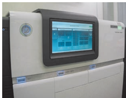
Мал. 28.1. Секвенатор — прилад для здійснення секвенування ДНК
